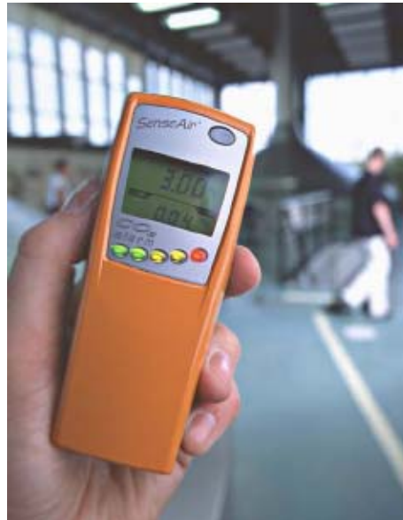
Mit den Maßen von 125x52x32 mm ist SenseAir ® Alarm ein einzigartiges, tragbares Messgerät.
